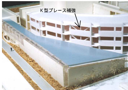
C. 既存校舎のK型ブレース補強
